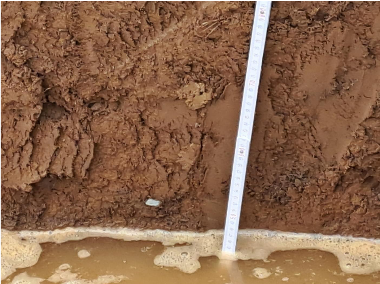
Abb. 2: Wasserstand zu Beginn des Versuches bei 0,445 m
