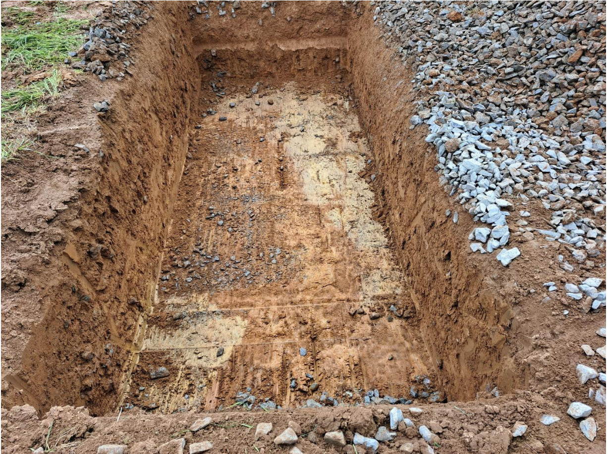
Abb. 1: Angelegte Schürfgrube VSV 1 (L=5,0 m, B=2,0 m, T=1,50 m) für Versickerungsversuch
