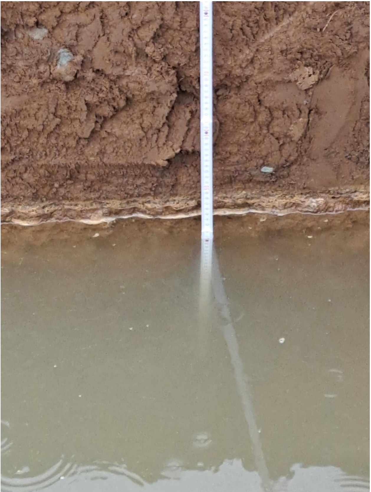
Abb. 4: Wasserstand 16 Std. 45 min. nach Beginn des Versuches bei 0,425 m
