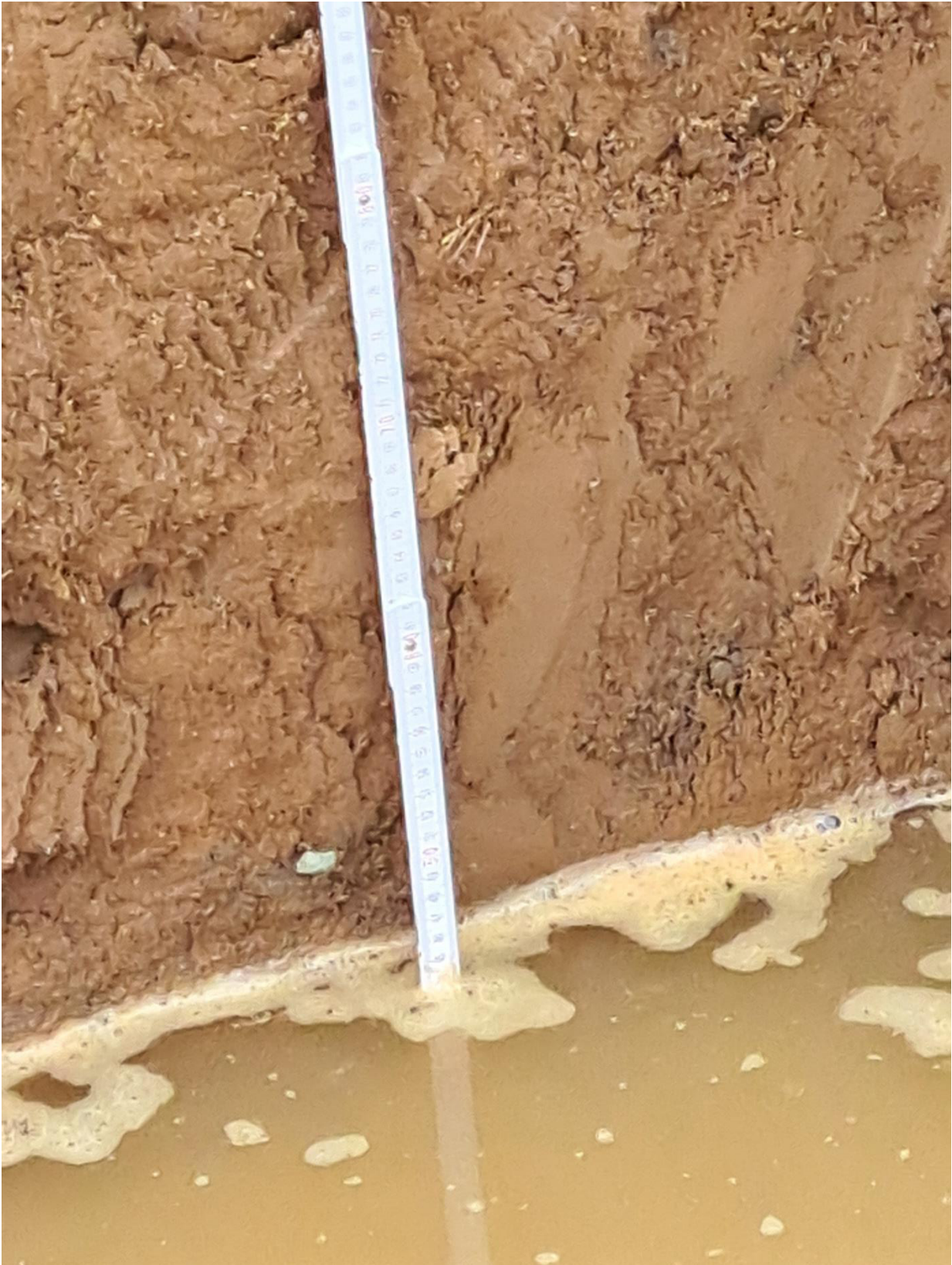
Abb. 3: Wasserstand 60 min. nach Beginn des Versuches bei 0,445 m
